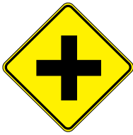
CRUCE DE CARRETERA
